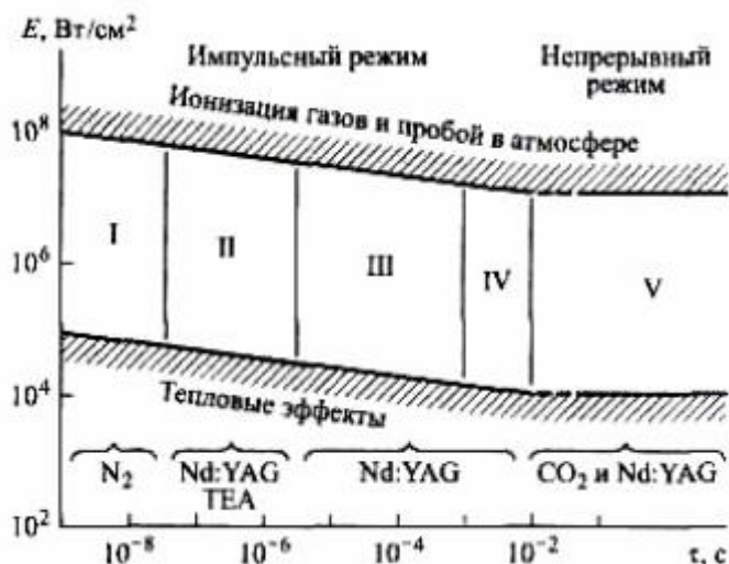
Рисунок 1. Использование лазеров для различных видов тепловой обработки материалов: I – испарение тонких пленок; II – скрайбирование, испарение пленок; III – сверление отверстий, перфорация; IV – точечная сварка, термообработка; V – глубокое проплавление, газолазерная резка, термообработка, термораскалывание. [4]
