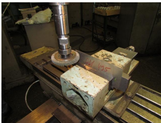
Рисунок 6 - Закрепление испытываемой пластины и щётки.
