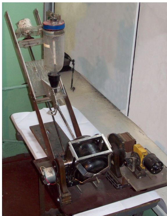
Рисунок 5 – Физическая модель Калдо-конвертера и системы дозированного ввода порошкообразной извести
