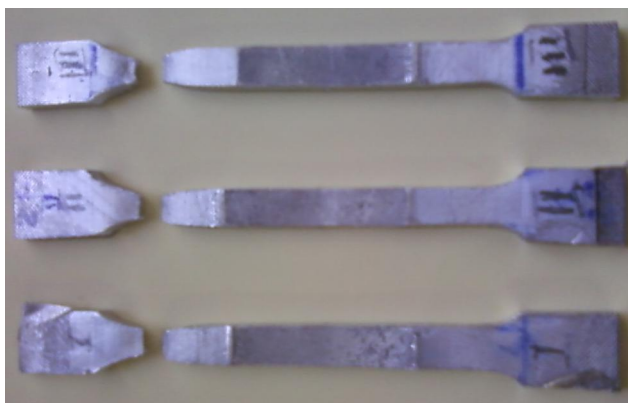
Рисунок 4 – Характер разрушения соединений, выполненных СТП по утолщённым кромкам
