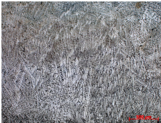
Рисунок 2 – Макроструктура сплава 30X10Г10, полученного наплавкой порошковой проволокой
