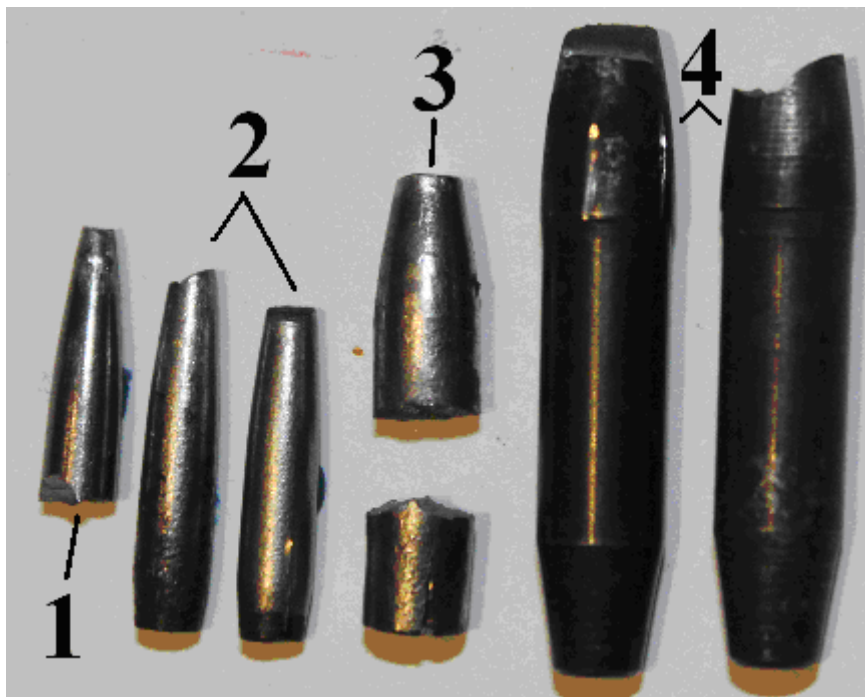
Рис. 3. Разрушение сердечников при испытании
