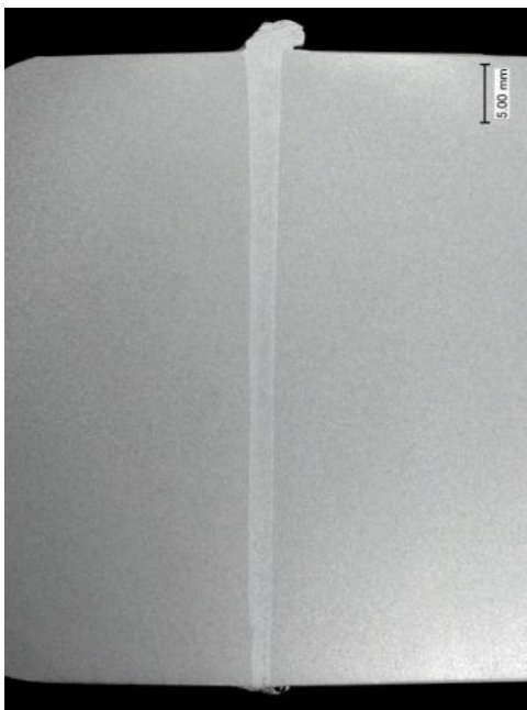
Рисунок 1 - Макроструктура сварного алюминиевого сплава 5083, выполненного ЭЛС с присадочной проволокой. Толщина 50 мм.
