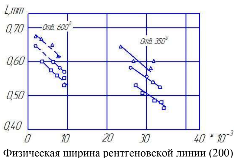
Рисунок 1 - Зависимость абразивного износа (L) сталей Δ -35, о -45, □ -У8 от физической ширины рентгеновской линии.
