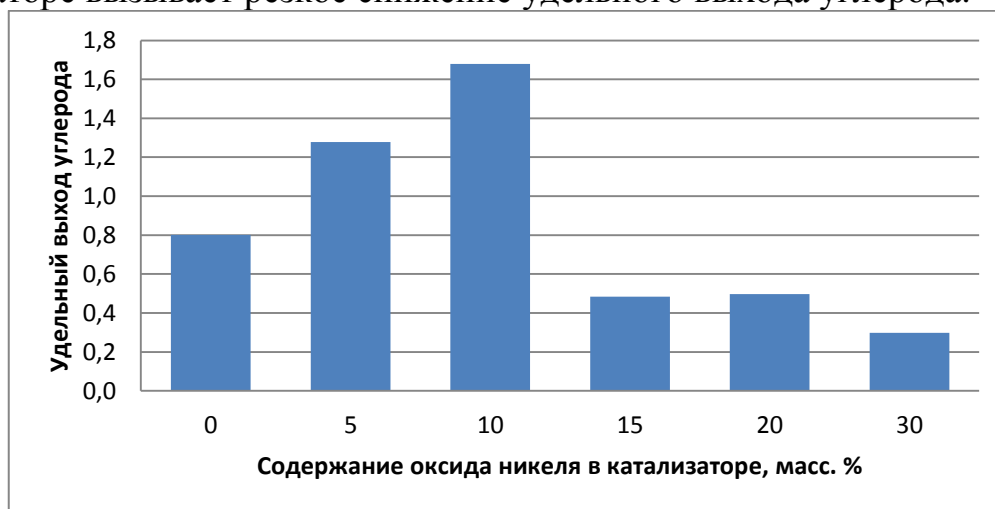
Рисунок 1 – Влияние содержания оксида никеля на удельный выход углерода.
