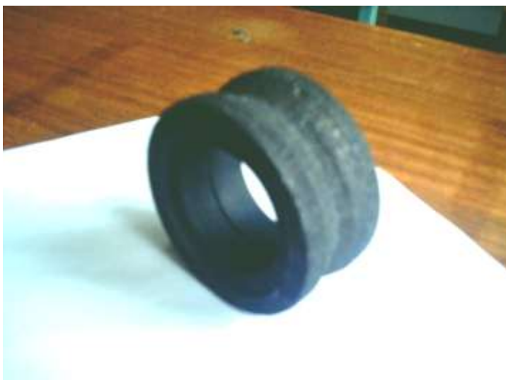
Рис.2. Ролик привалковой арматуры прокатного стана покрытый электроконтактным способом.
