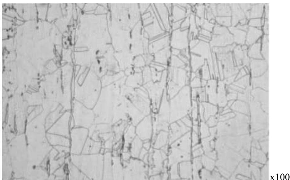
**Рисунок 1 – Структура стали 12Х18Н10Т в исходном состоянии**
