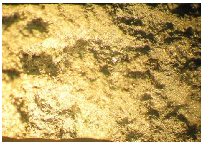
Рисунок 2 - Излом в зоне термического влияния
