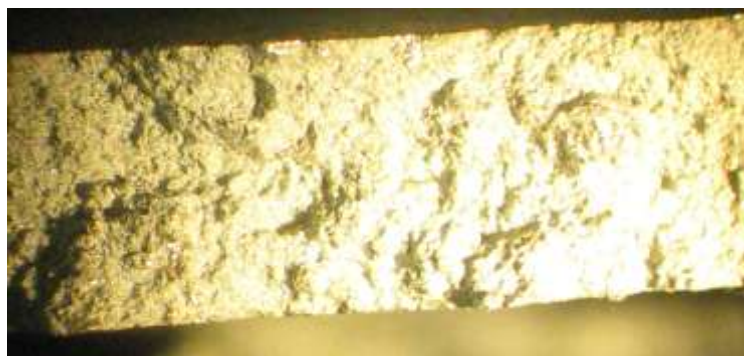
Рисунок 3 - Излом по основному металлу
