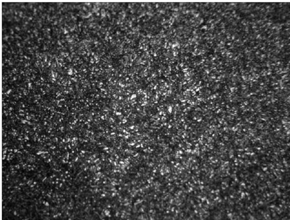
Рисунок 2 – Микроструктура поверхностного слоя детали "втулка". Увеличение x500
