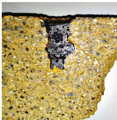
Рисунок 3 – Образец после проверки глубины проникновения шлака
