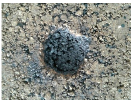
Рисунок 2 – Образец после испытаний на шлакоустойчивость
