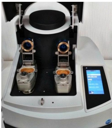
Рисунок 1 – Измельчение глины на наномельнице Emax
