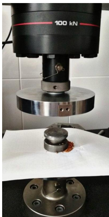
Рисунок 4 – Процесс прессования экспериментальных образцов
