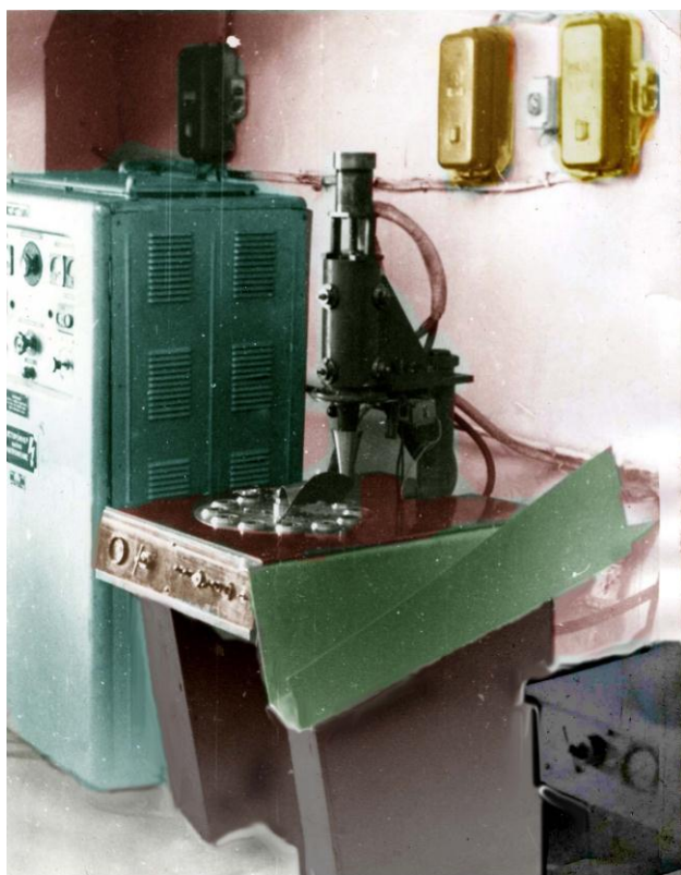
Рисунок 4 – Общий вид и схема установки для сварки изделий из полистирола УСМ-11
