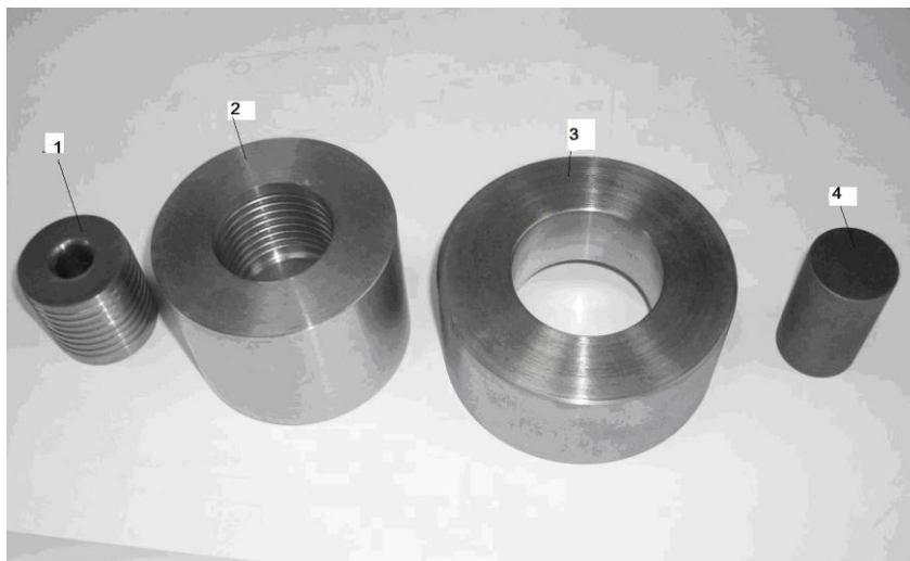
Рисунок - 4. Элементы составной матрицы и приспособления: 1 – вставка, 2 – корпус, 3 – опорное кольцо, 4 – ударник.
