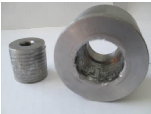
Рисунок 6 - Твердосплавная втулка и корпус после эксперимента.
