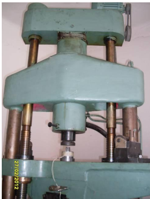
Рисунок 5 - Опытный образец, установленный на универсальную испытательную машину.
