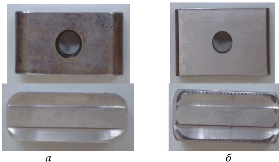
Рисунок 5 – Форма предлагаемых призматических режущих пластин: а) по передней; б) по задней поверхностям
