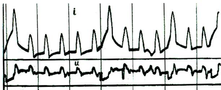
Рисунок 3 – Осциллограмма сварки в CO_2 от выпрямителя ВДГ-301 с наложением импульсов от генератора ГИ-ИДС (частота импульсов 100 Гц, длительность импульса 3 мс)
