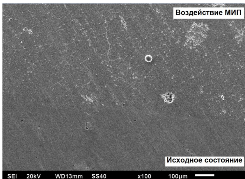
Рисунок 1 – SEM–изображение поверхности БВТС в исходном состоянии и после мощного ионного пучка
