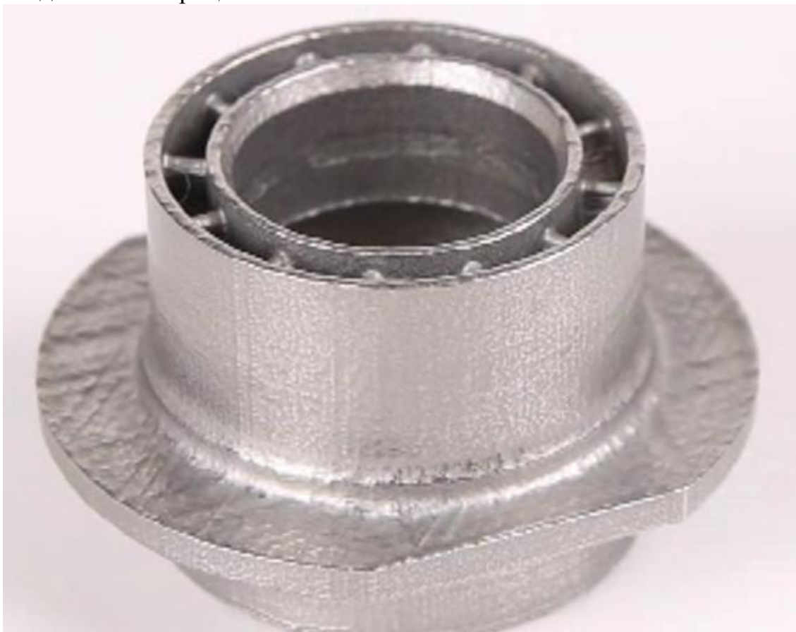
Рисунок 2 – Завихритель, полученный селективным лазерным спеканием (SLS)
