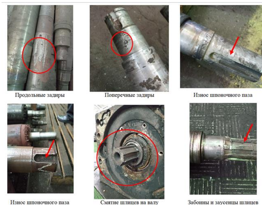
Рисунок 2 - Характерные дефекты деталей
