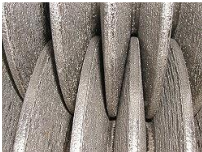
Рис.2. Ролики с твердосплавным износостойким покрытием дробильной установки для измельчения резины
