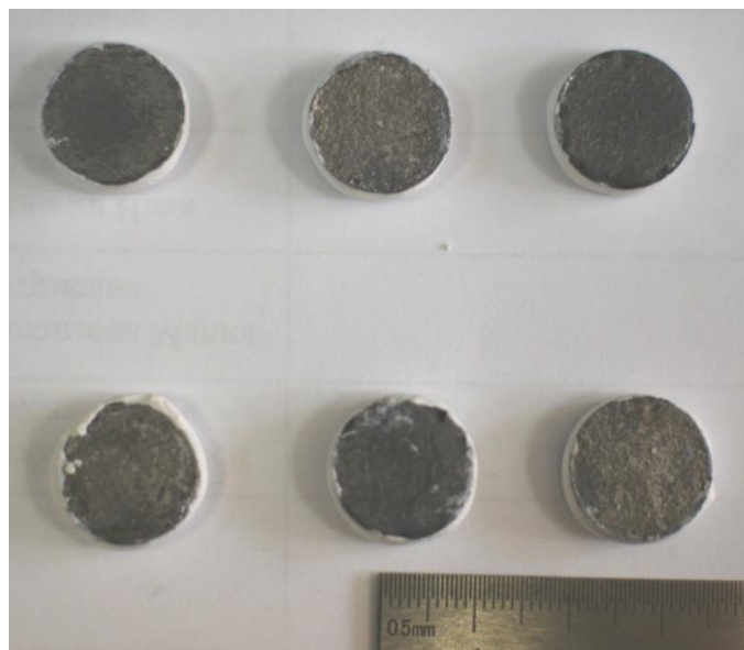
Рисунок 1 – Исходные образцы перед термоциклированием с различным содержанием YSZ в подслое ТЗП: нижний ряд с 15%YSZ, верхний ряд с 30% YSZ
