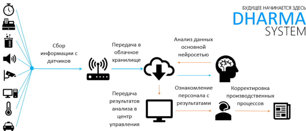
Рисунок 2 – Архитектура основной нейросети проекта «DHARMA»
