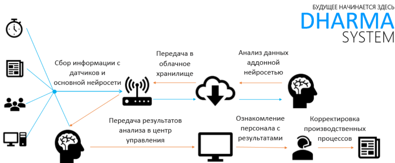
Рисунок 3 – Архитектура аддонной нейросети проекта «DHARMA»
