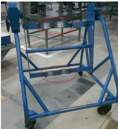
Рисунок 2 – Монтажная стойка с отмеченными фиксаторами
