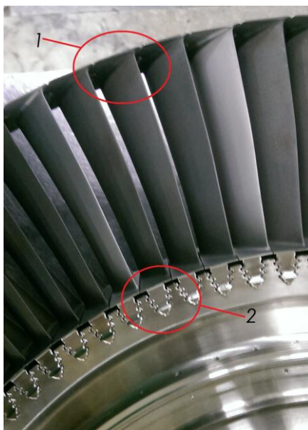
Рисунок 1 – Лопатки ротора ТНД: 1- бандажная полка; 2 - крепление типа "елочка"
