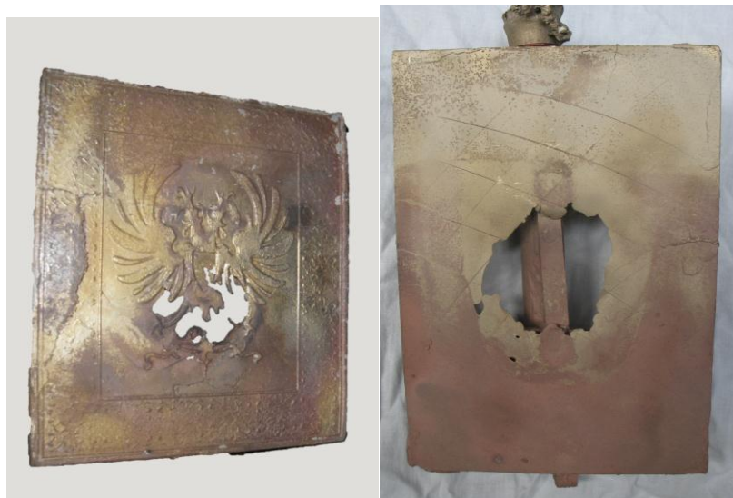
Рисунок 1 – Брак в художественных отливках
