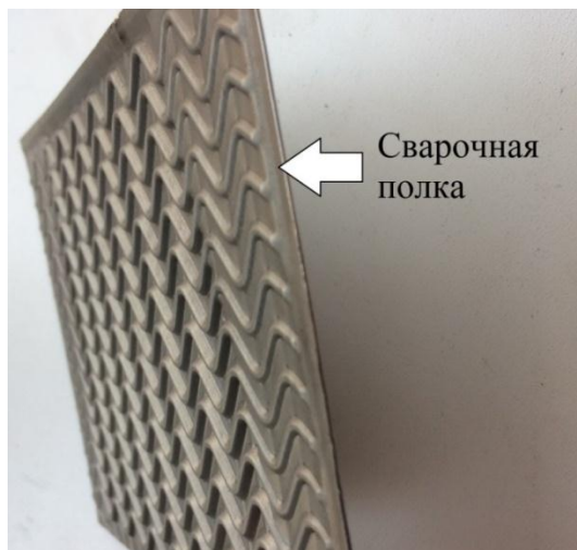
Рисунок 1 – Сварка двух пластин в конверт
