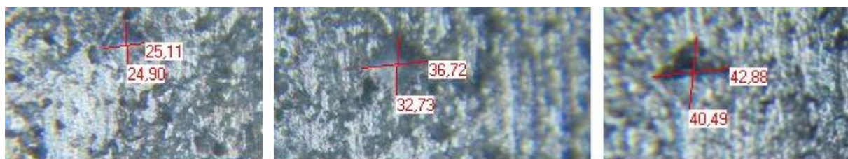
Рис.1 Опытные металлические образцы с отпечатком алмазной пирамидки после индентирования
