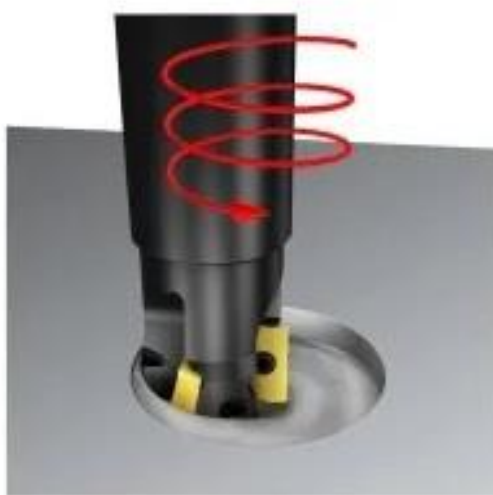
Рисунок 6 – Метод фрезерования с врезанием под углом (одновременно по 2-м осям)
